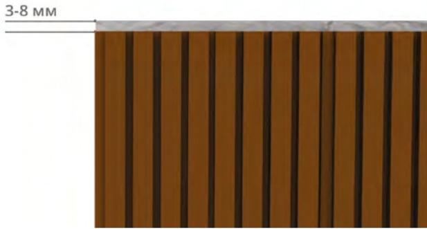
**ЗАЗОР СВЕРХУ 3-8 ММ**
