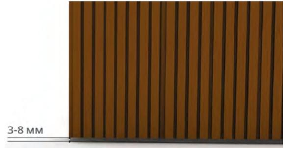
**ЗАЗОР СНИЗУ 3-8 ММ**
