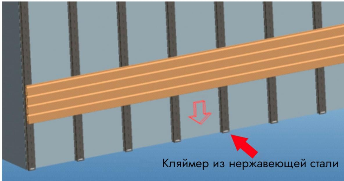
Вставьте фасадную доску **Bamberg Nordic** в зафиксированный кляймер, обратите внимание на положение и направление настенной панели и зажимов.
