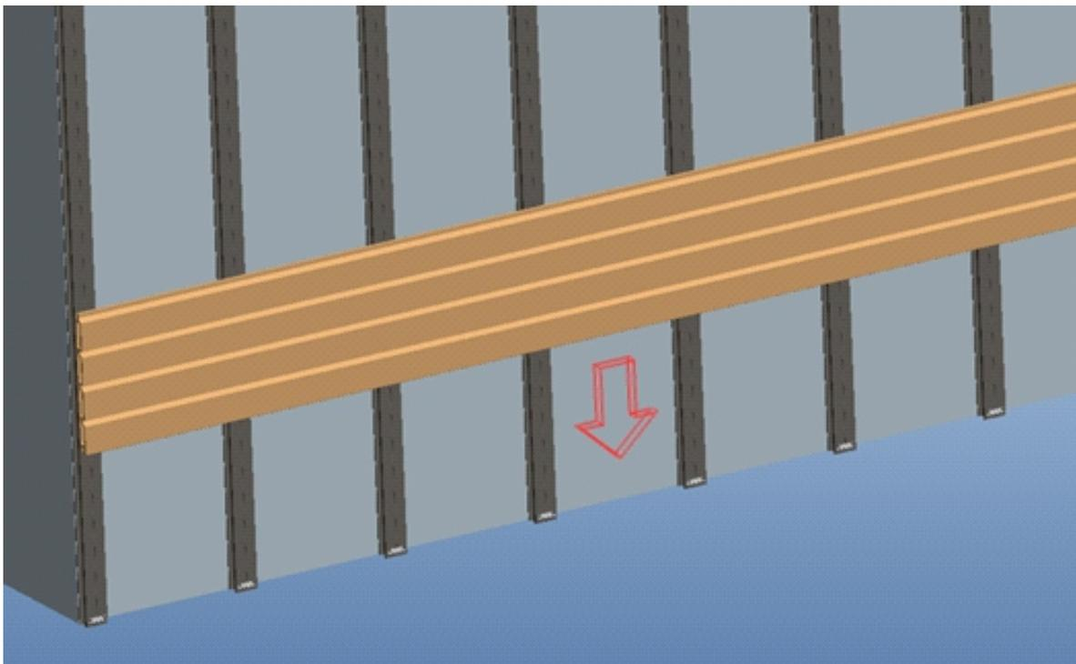
Вставьте кляймер из нержавеющей стали в боковой паз фасадной доски **Nordic**, обратите внимание на положение и направление стеновой панели и зажимов, затем закрепите зажим на лаге саморезом 4\*20.
