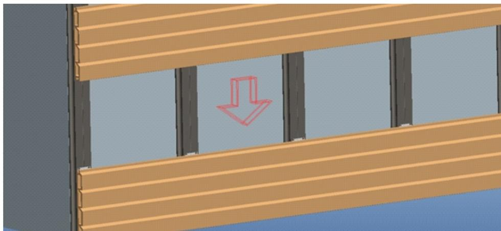
При стыковке двух панелей в длину необходимо оставлять компенсационный зазор от 3 до 8 мм. Величина зазора зависит от температуры воздуха, когда осуществляется монтаж.
