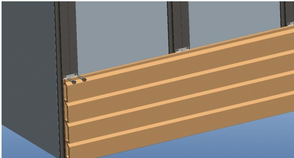
Следующая фасадная панель устанавливается сверху и также крепится. Описанный выше этап монтажа следует повторить необходимое количество раз вплоть до окончания процесса монтажа фасада.
